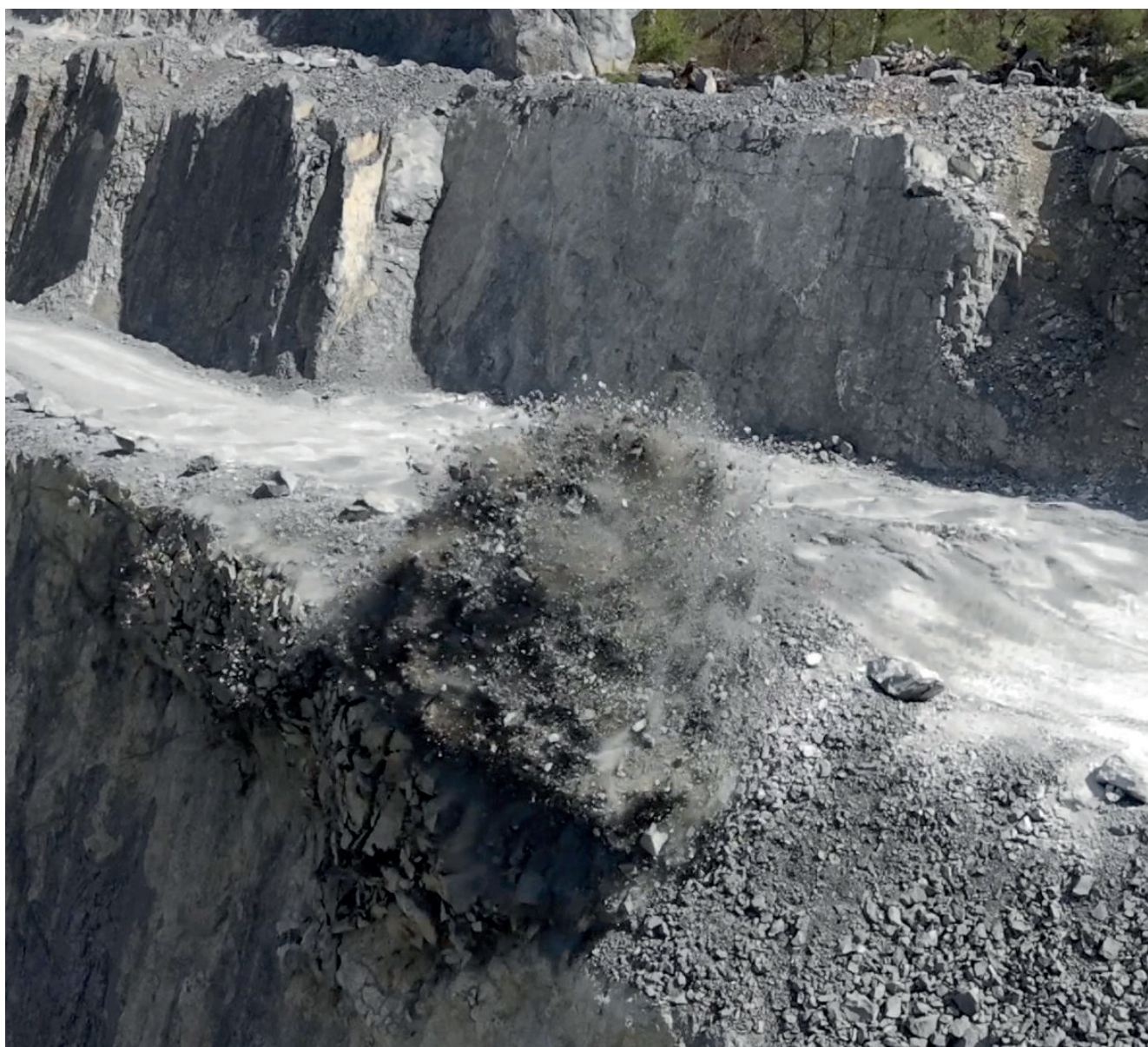
Eindrucksvoller Abschluss des Praxisteils: prognostizierter Steinflug infolge einer lokalen Schwachstelle bzw. zu geringer Vorgabe im Bereich der freien Bruchkante.
